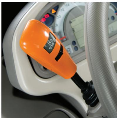
**Inversor hidráulico** com comando sob o volante.
