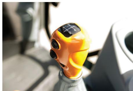
Alavanca das velocidades com botão **"Comforto Clutch"** - o operador pode mudar as velocidades sem usar o pedal da embraiagem.
