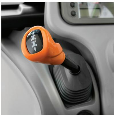
**Inversor mecânico** com comando sob o volante.
